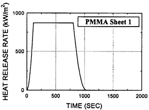
Fig. D15. PMMA 1" black (cb) w/frame (test 1461), Sheet
