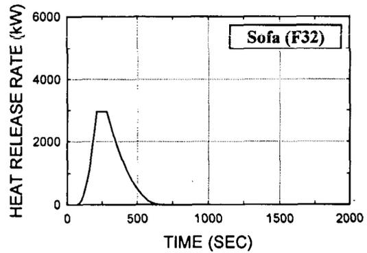
Fig. B17. Upholstered\sofa, F32, wood\frame, pu foam-fr, olefin test 38
