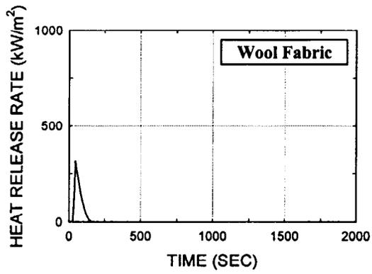
Fig. D25. Wool fabric/neoprene padding (test 722), Composite
